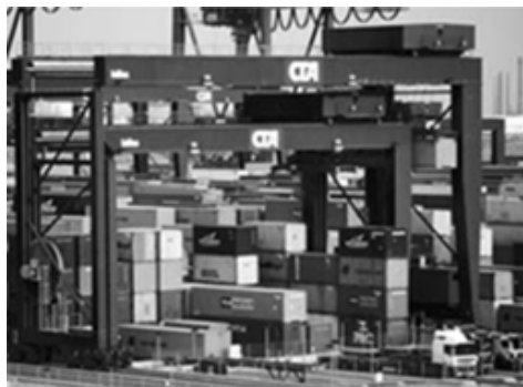
شکل ۳. جرثقیل موقعیت‌های چینش (در اینجا: RMG دوگانه).
