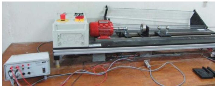
شکل ۱۴- دستگاه ارتعاشات شافت دوار برای تعیین سرعت بحرانی
