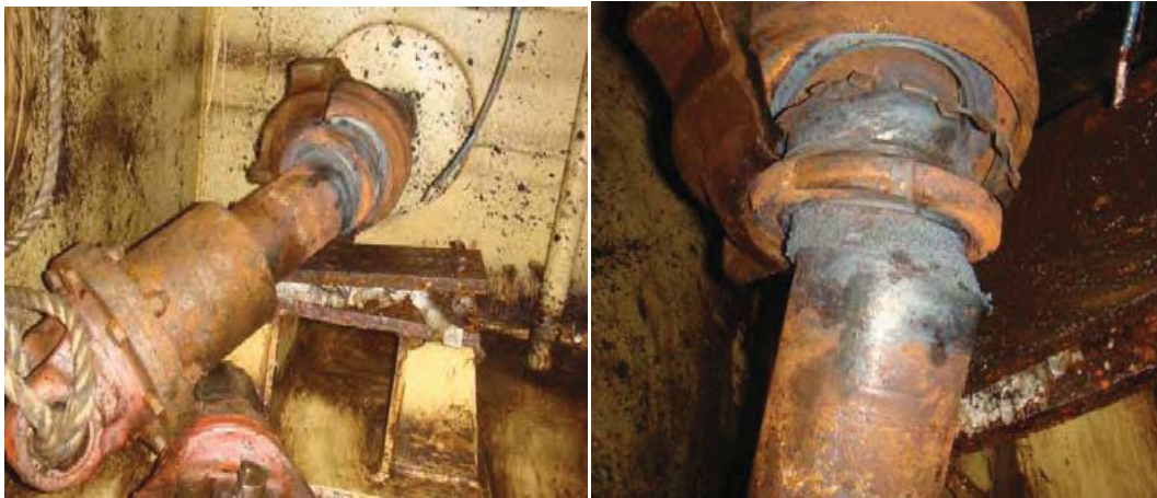
شکل ۱- نمونه‌های تخریب شده در اثر ارتعاشات شافت‌های دوار در کشتی
